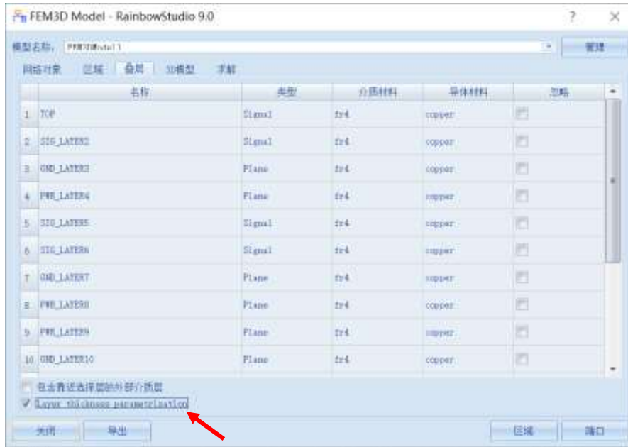
图 5-119 选中 Layer thickness parametrization
