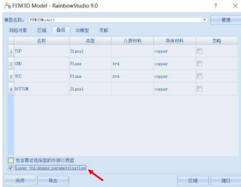
图 5-36 选中 Layer thickness parametrization
