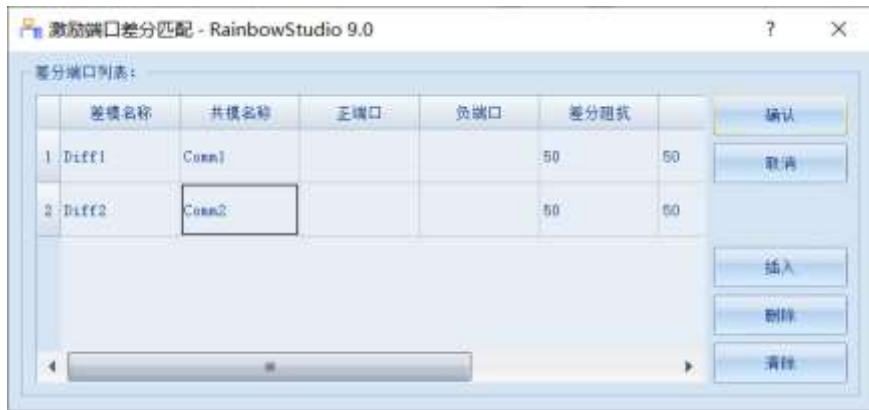
图 5-88 新建差分端口和共模端口
